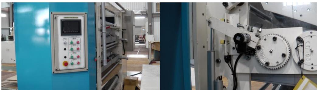
使用高階析度 ENCODER 來控制各間隙,可隨車速連續式無間斷自動調整糊隙及設定觸壓板或騎轆加大減小之變化，確保產品品質及產能。
