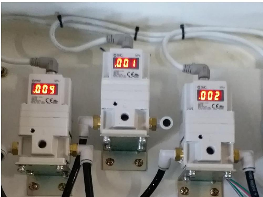
使用高解析 ENCODER 及精密電空比例閥經過 PLC 程式演算來控制張力，使得高速生產中能高速換紙無須停機,達到產能要求。
