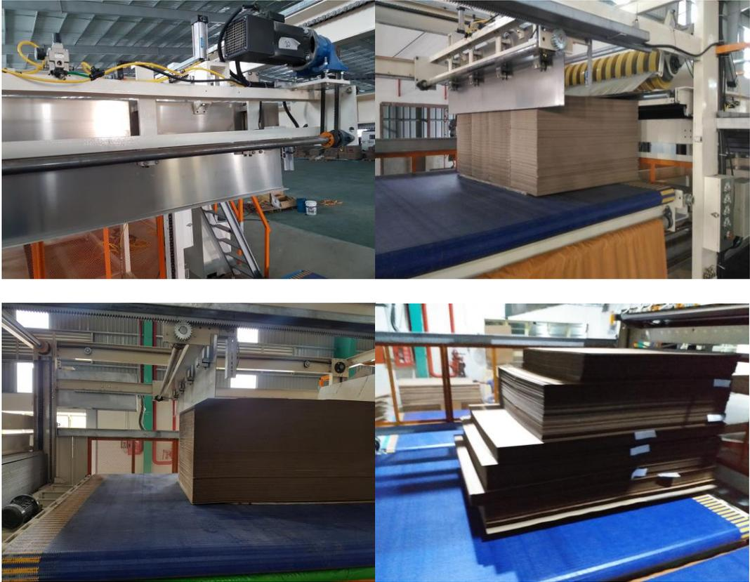
同樣使用高解析 **ENCODER** 搭配伺服馬達控制紙長擋板動作，在生產及換單過程中精準的自動變換擋板位置使得成品整齊堆疊，亦可在生產中快速移動擋板達到高速多單堆疊之效果，提升生產效能。
