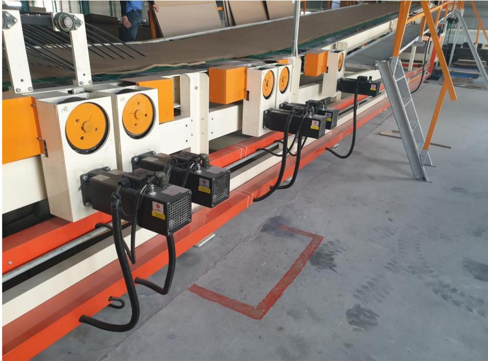
使用伺服馬達搭配高解析 ENCODER 能高精準計算紙板位置，讓高速生產換單時能精準換批抽離，達到高速準確換單效能。
