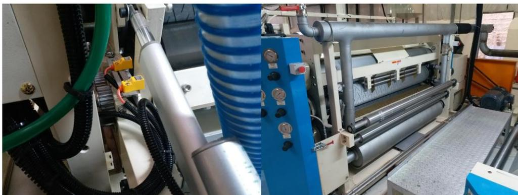
經由 PLC 控制使得生產過程中因生產速度不同所需的糊量變化，採隨車速連續式無間斷自動調整糊隙，可由操作員自行輸入設定記憶，減少生產中因速度不同產生的損耗
